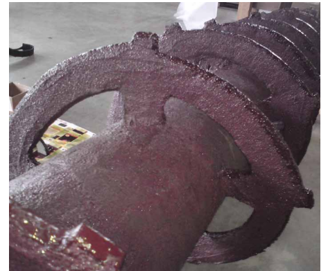
已敷涂贝尔佐纳 (Belzona) 1811 的螺旋钻
